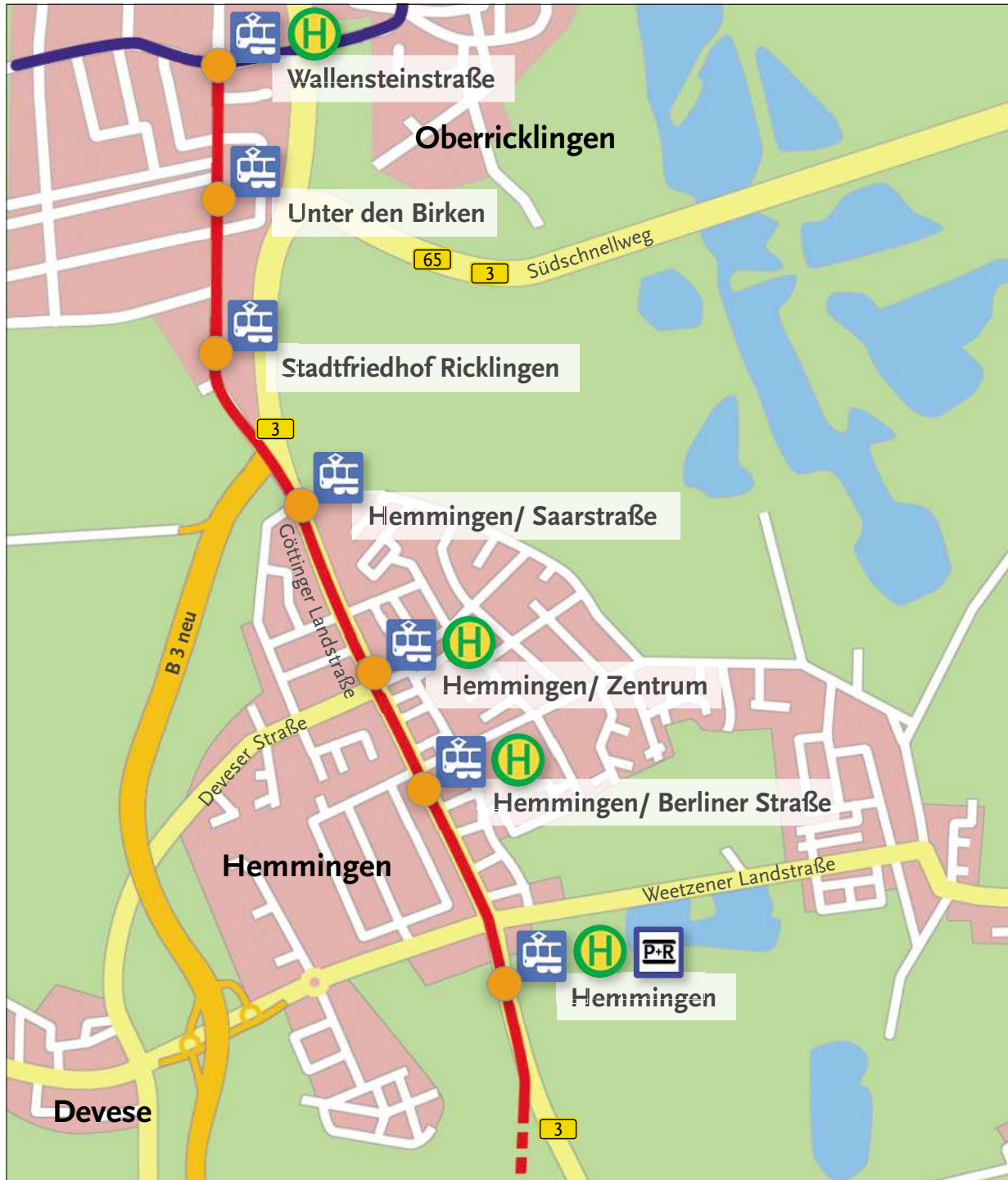
Geradeaus durch Hemmingen-Westerfeld: Die Planung für die Stadtbahntrasse sieht ein Gleisbett in Mittellage vor. An den markierten Haltestellen ist es möglich, in Busse umzusteigen. Im Süden ist eine Park-and-ride-Anlage vorgesehen. Grafik: Erdbrink
